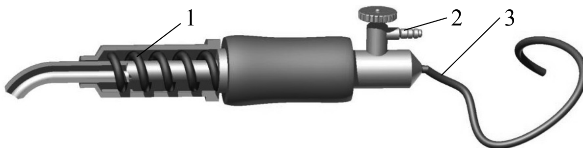
Obr. 3. Schéma pistole na svařování polymerů horkým plynem.
